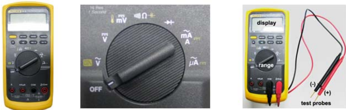
그림 1. 멀티미터의 구조, 세부기능 그리고 탐침연결.
